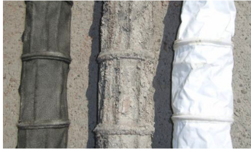
De izquierda a derecha: manga “limpia”, manga usada y manga nueva. Cualquier parecido de la “limpia” con la nueva es pura coincidencia
